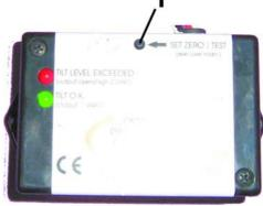
O modo autotest simula um inclinação que excede l' ângulo autorizado. Um controlo interno é efectuado.
